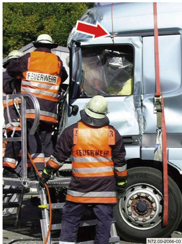
Sicherung der Tür mit Seil
