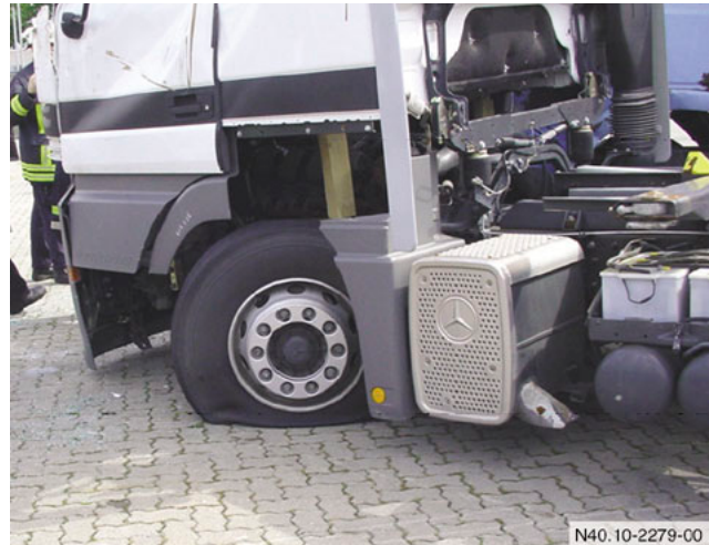
Zum Entlüften des Reifens Ventil herausschrauben
