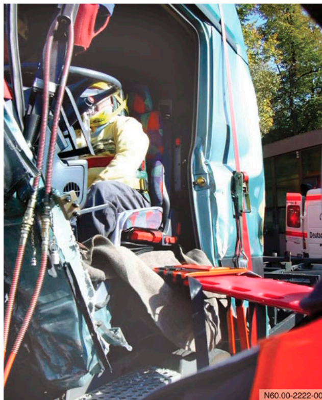
Befreiungsöffnung über die Fahrertür
