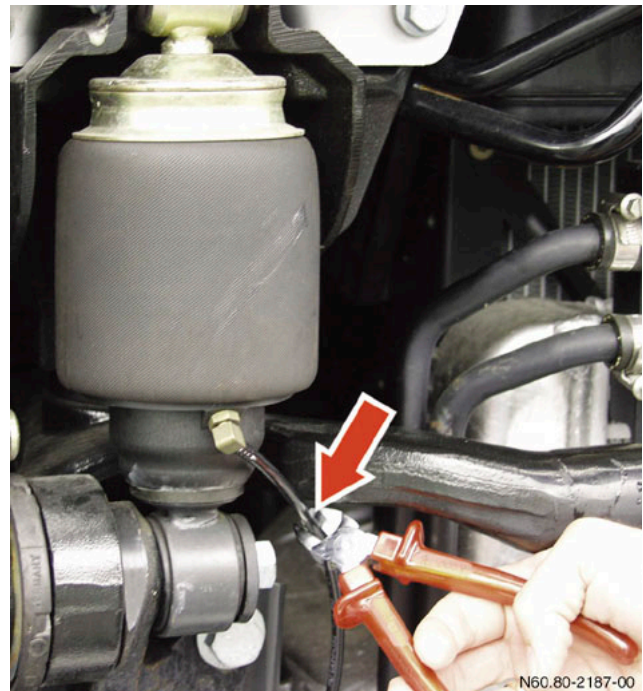
Luftleitung am Luftbalg durchtrennen
