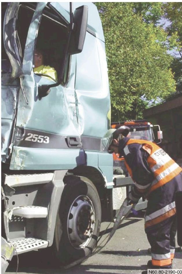
Spanngurt um Rahmen und Fahrerhaus
