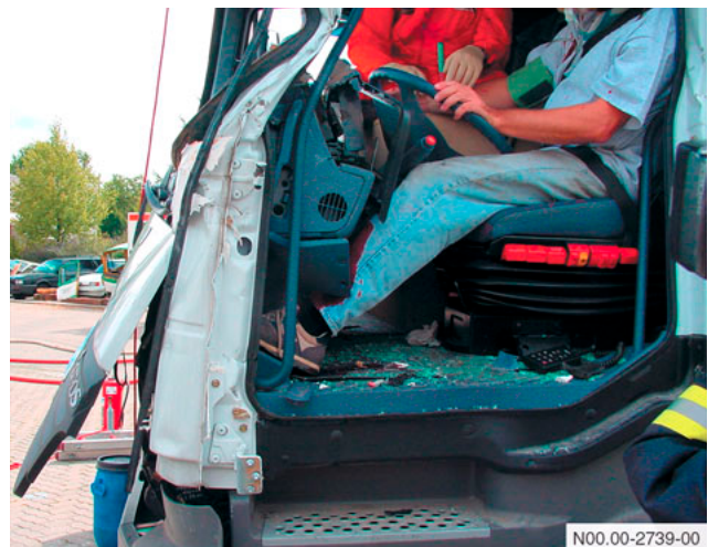
Deformierter Fußraum (Rettungsübung Ludwigshafen 15.09.2001)
