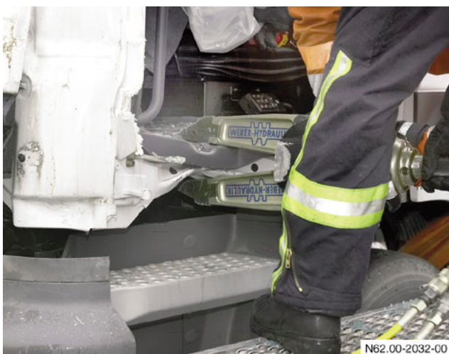
Zusammendrücken des Schwellers
